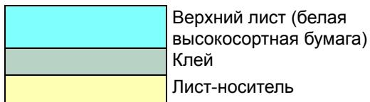
Бумага этикетки имеет структуру, состоящую из трех слоев, как показано на схеме. Верхний лист печатается. Клейкий слой состоит из чувствительного к давлению клейкого вещества. Лист-носитель (его также называют линейным или подкладочным листом) удерживает этикетки до использования. Из-за сложности своего состава этикеточная бумага с kleenой подкладкой наиболее подвержена проблемам при печати.
