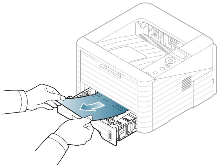
Если замятая бумага не извлекается или ее не видно, проверьте, не замялась ли она в области термофиксатора или картриджа (см. «Замятие внутри устройства» на стр. 73).
