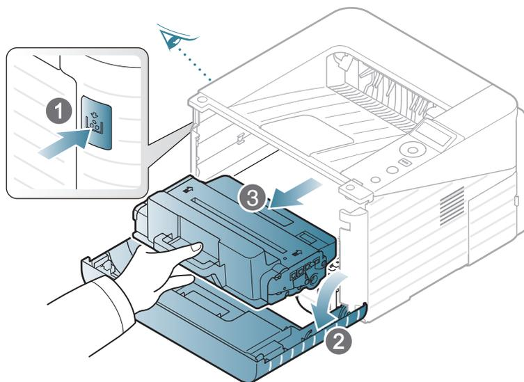
**2** Покачайте картридж из стороны в сторону 5—6 раз, чтобы тонер в нем распределился равномерно.
