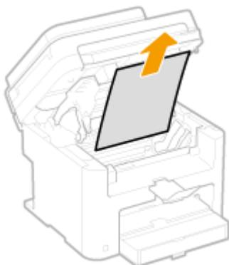
**3** Проверьте наличие замятой бумаги внутри направляющей выхода бумаги.
