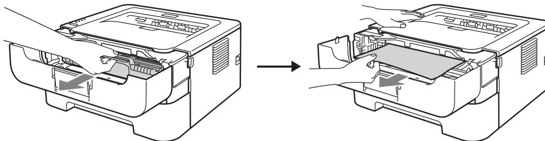
Если извлечение узла фотобарабана и тонер-картриджа затруднено, не прикладывайте излишнюю силу. Вместо этого перейдите на шаг 4.
